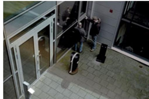
*Compensación de contraluz.* La exposición automática de una cámara intenta obtener el brillo de una imagen para que ésta aparezca como la vería el ojo humano, sin embargo una contraluz intensa puede provocar que los objetos en primer plano aparezcan oscuros. Las cámaras con compensación de contraluz intentan ignorar áreas con mucha iluminación, como si no existieran. Esto permite que se vean los objetos en primer plano, aunque las áreas brillantes se muestren sobreexpuestas.
